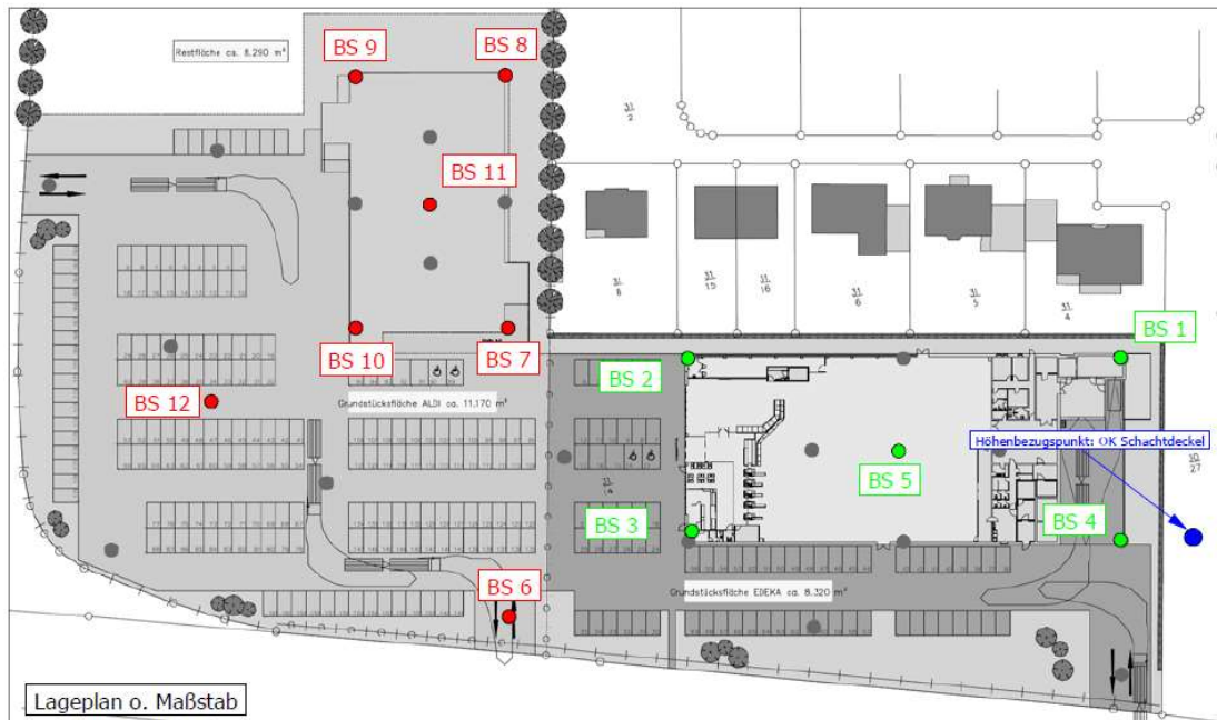
Abbildung 2: Lage der Kleinbohrungen (unter Berücksichtigung eines alten Bbauungskonzeptes)
